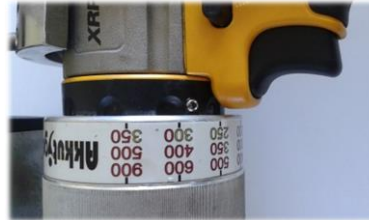
Après dévissage de la vis de blocage, le couple de rotation de 770 Nm peut être obtenu impulsivement (entraînement direct, plus d'embrayage à friction, sélecteur de vitesse sur la position 1)
