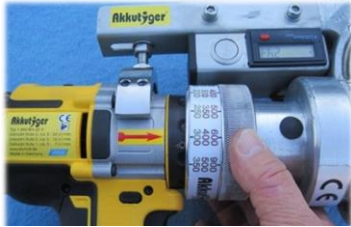
Sélection du couple de rotation à l'aide de la bague de réglage à friction de 100 à 500 Nm
