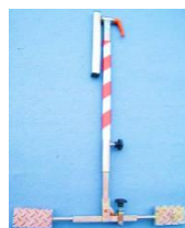
Trépied télescopique en inox pour couple de rotation maxi 400 Nm Pliable pour le transport
