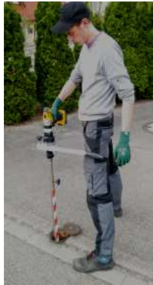
(3).... Ou avec tige d'étalement en appui sur la jambe Jusqu'à 250 Nm Conforme CE
