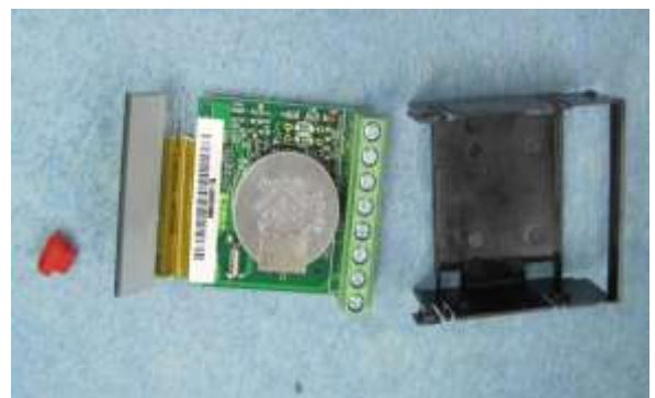
Photo 2 Pile soudée sur le circuit imprimé
