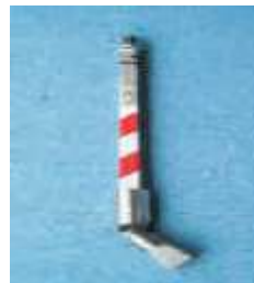
Tige de manœuvre télescopique en inox avec cardan et carré d'entraînement interchangeable Livré avec carré de 30/30 interchangeable Lg 800/1200 mm Autres sur demande
