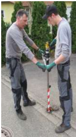
(2)...Ou 2 personnes avec 2 poignées jusqu'à 400 Nm Conforme CE
