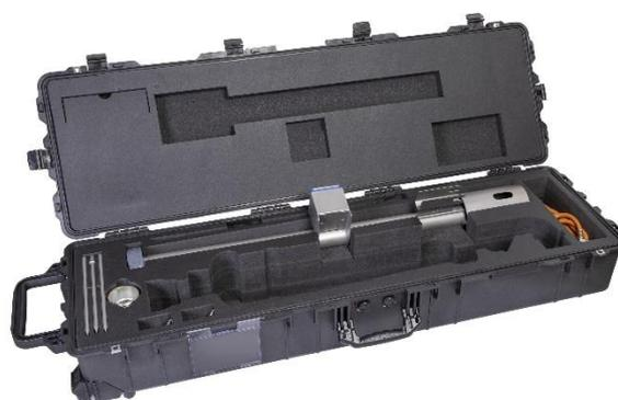
Prendere tutti e tre i cappucci di protezione/tappi (**J**, **K** e **L**) dal trolley di trasporto e applicarli nei punti corrispondenti. Riporre il tubo montante superiore nel trolley di trasporto e ruotare il controllo di fiamma verso l'alto per facilitare l'alloggiamento del tubo montante inferiore.
