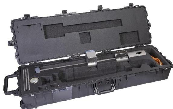
Nehmen Sie nun alle drei Schutzkappen/Stopfen (**J**), (**K**) und (**L**) aus dem Transport-Trolley und schrauben Sie diese wieder entsprechend auf. Legen Sie das obere Steigrohr in den Transport-Trolley und drehen die Flammenüberwachung nach oben, um ein einfaches Verstauen des unteren Steigrohres vorzubereiten.
