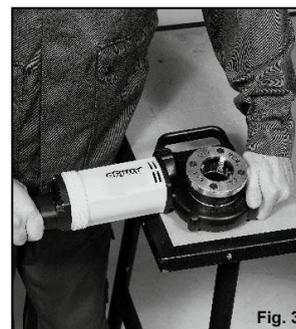
Die Schneidköpfe stehen über die hintere Gehäusewand hinaus. Dieser Überstand erleichtert das Herausnehmen des Schneidkopfes aus der Antriebsmaschine, indem dieser überstehende Rand kräftig gegen eine Fläche oder Kante gedrückt wird. (Fig. 3)
