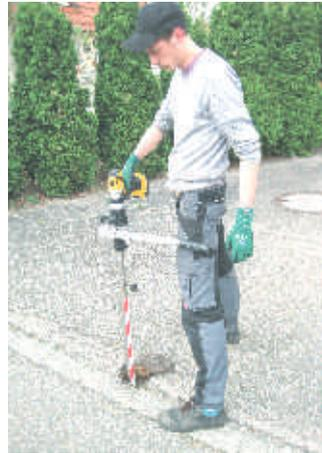
3... oder Drehmomentabstützung mittels Anlehnposition bis 250 Nm CE u. BG konform
